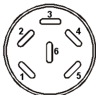
Рисунок 9: Расположение контактов в гнезде DIN для аналогового выхода
